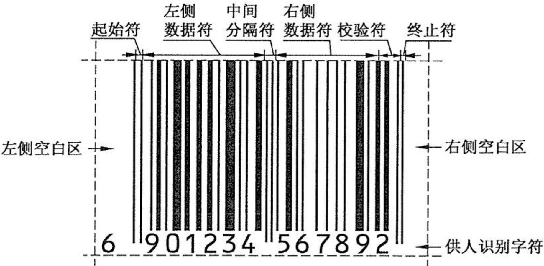
图 1 EAN-13 条码的符号结构
