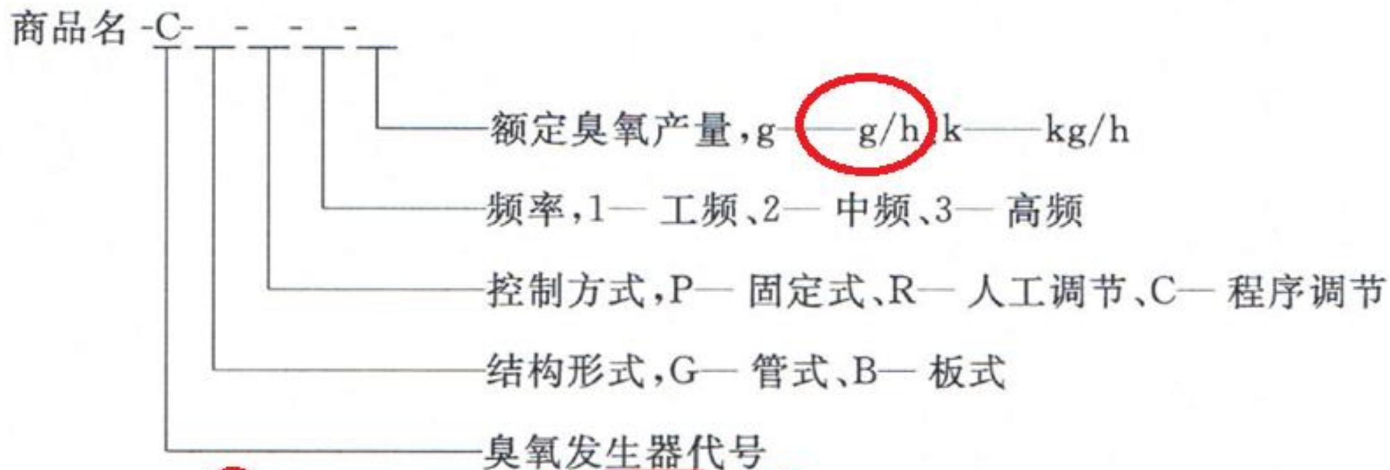
示例: ××牌-C-G-C-2**5g**, 表示××牌**每小时额定臭氧产量为 5 g**的中频程序调节管式臭氧发生器。
